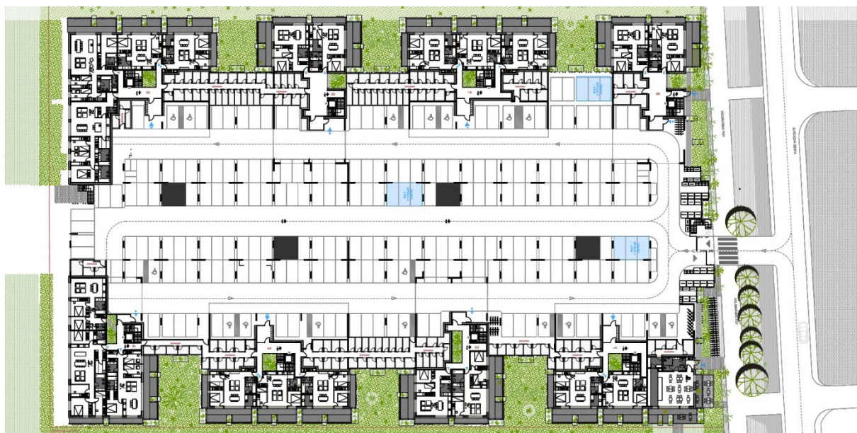
Slika 25: Zagotavljanje PM za osebna vozila in kolesa pod ploščadjo na nivoju terena (vir: Ofis arhitekti)
